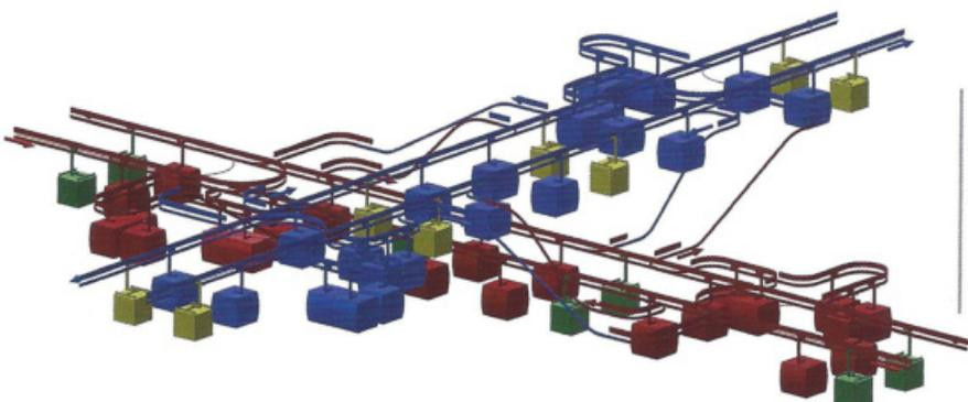
Abb.: Seilbahnbahnhof. Die „blaue Linie“ überquert die „rote Linie“ mit Auf- und Abfahrten. Gelb und grün sind die Lastengondeln.
